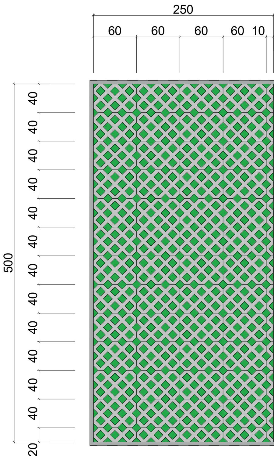
Une place de stationnement de 2,5 mètres par 5 mètres contient 625 pavés, soit 50 pavés au mètre carré.
