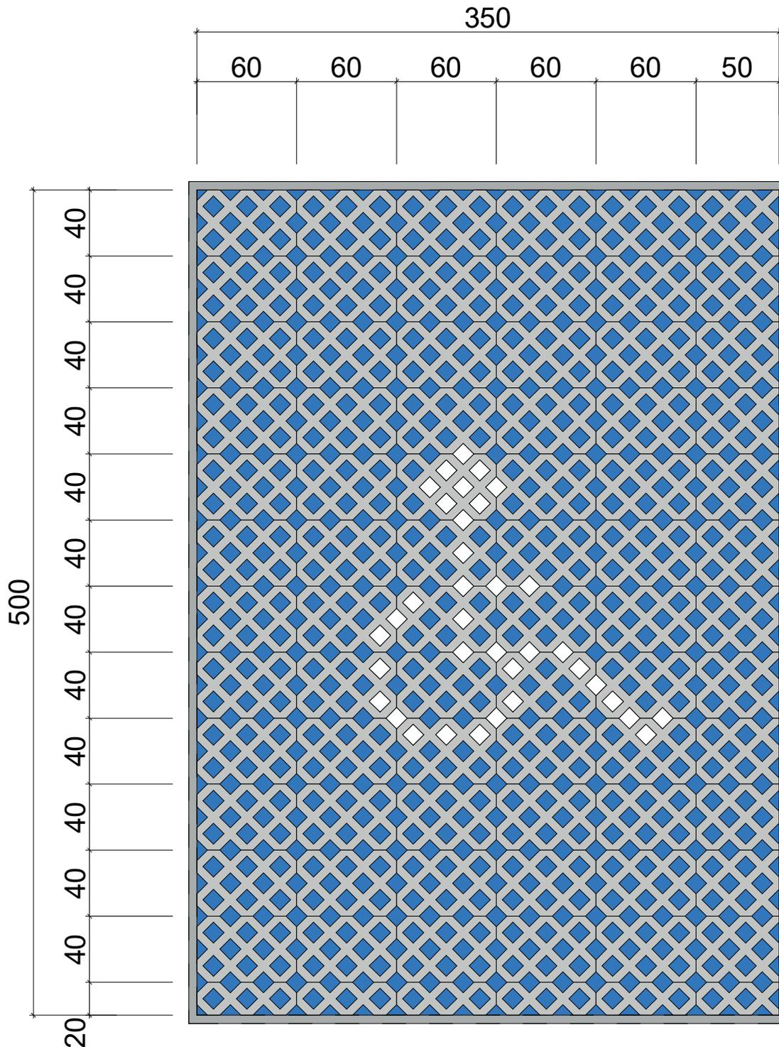
Une place de stationnement PMR de 3,5 mètres par 5 mètres contient 875 pavés, soit 50 pavés au mètre carré.
